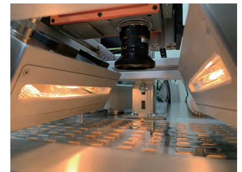
ハイパースペクトルカメラを用いた製剤の品質検査
